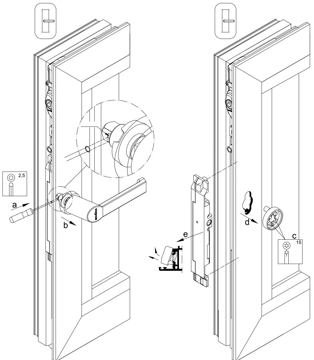
1. Fenstergriff in Drehstellung bringen. Die Rastung mit Schraubendreher durch die Bohrung zurückdrücken, bis Fenstergriff heraus springt, oder mit etwas Kraft herausziehen.
