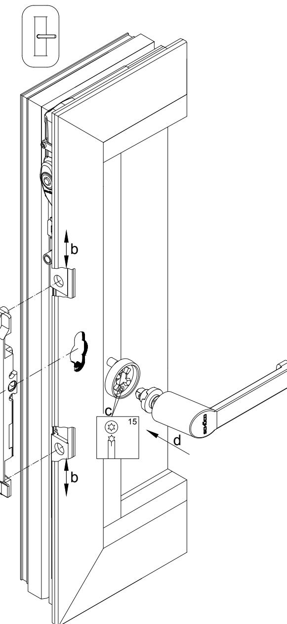
1. Kammergetriebe einschwenken und mit Riegelstange koppeln und mit Rosette verschrauben.
